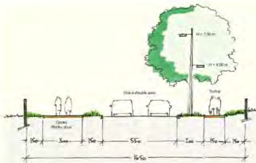
Voie structurante de type 1-2 (Sans échelle)
